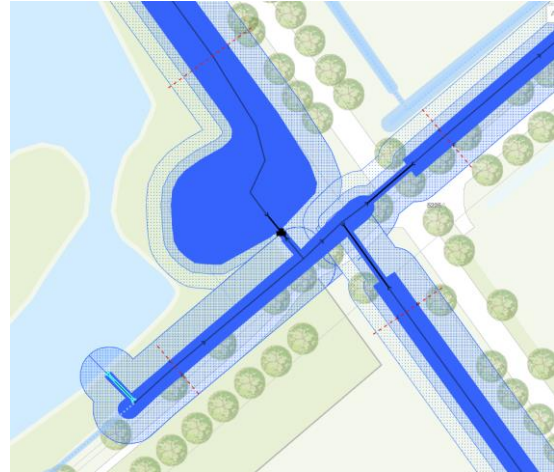
Foto 6: Uitstroming via onder water gelegen verbindingsduiker DSH0008041 tussen de waterwinplas Brabantse hoek en A-watergang ZL-24 (klein traject), die het water in noordoostelijke richting afvoert naar de ZL-20 (Waterschap De Dommel, 2025). De A-watergang wordt tevens vanuit de noordwestzijde via een gemaal wordt gevoed door A-watergang ZL-23, die de afwatering van de gronden ten noorden en noordwesten van de Leemkuilen verzorgt. A-watergang ZL-20 wordt tevens vanuit het zuidoosten gevoed door bovenlopen van watergang ZL-20 die de afwatering van de gronden ten zuiden van de Leemkuilen verzorgt. Voor een overzicht van de leggerwatergangen wordt verwezen naar de overzichtkaart in Bijlage 1.
