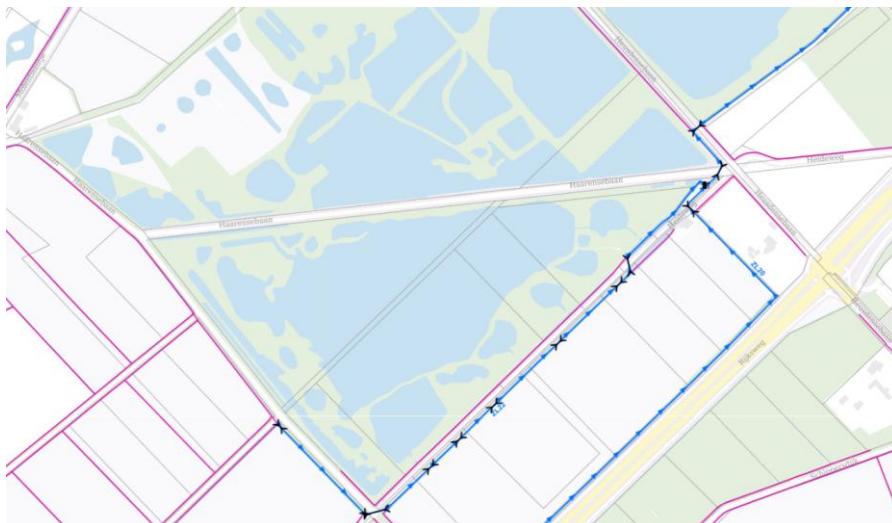
Figuur 9: Legger waterschap De Dommel met hierop aangegeven de ligging van de A-watergaten aan de zuidzijde van het gebied en gemaal op de kruising Heideweg en Haarense baan dat het water bij peilen hoger dan 7,6 m. +NAP uit de ZL-22 in de ZL-20 pompt. Strooming water in de A-watergaten is overwegend zuidwest naar noordoost.
