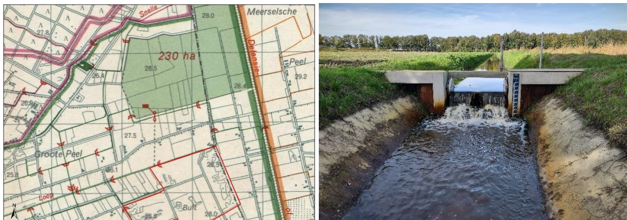
Figuur 3-14: Bemalingsgebied Vliegbasis De Peel (linker afbeelding) volgens Waterstaatskaart 5 e editie 52 Venlo West 1 uit 1986 (Rijkswaterstaat 2022). In rood de begrenzing van De Bult. De foto (11 oktober 2022) rechts laat het verval zien over een stuw 261JB aan de Koperenpeel stroomafwaarts van dit bemalingsgebied.
